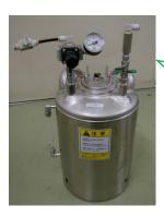
ー**フラックス加圧タンク**ー タンク用レギュレータ付き レベルゲージ付き
